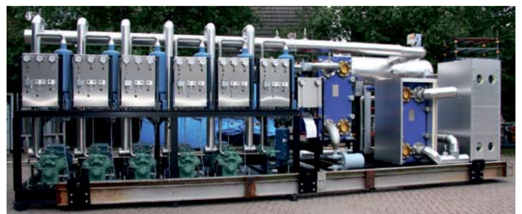
NH3-chiller met een koelvermogen van 1,1 MW: van ontwerp ... naar een gerealiseerd systeem.
